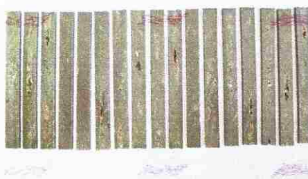
Flexão – ASTM D 790 Flamabilidade – UL 94 HDT – ASTM D 648
