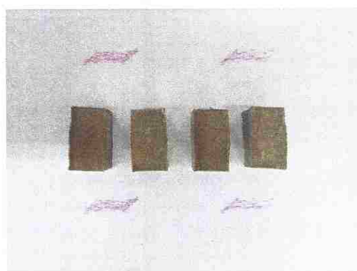
Compressão – ASTM D 695 (já testados)
