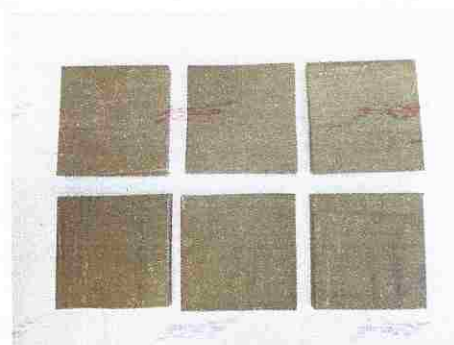
Absorção de Água – ASTM D 570 Vicat – ASTM D 1525
